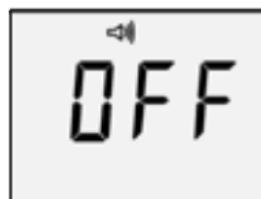
Si, à l'écran Réglages, l'appareil ne détecte aucun enfoncement de touche pendant 2 secondes, il passe au réglage suivant.
