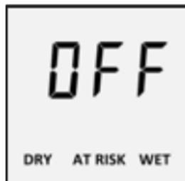
Si, à l'écran Réglages, l'appareil ne détecte aucun enfoncement de touche pendant 2 secondes, il passe au réglage suivant.
