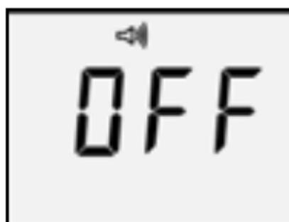
Si la unidad no detecta ninguna pulsación durante 2 segundos en la pantalla de ajustes, avanza hasta el siguiente ajuste.
