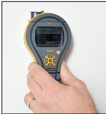
Figure 3 : Prise de relevés d'humidité relative
