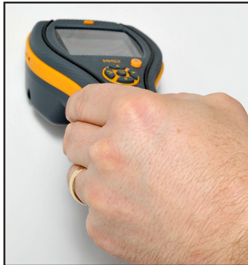
Figure 2 : Utilisation de l'humidimètre à broche
