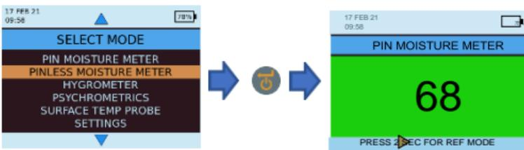
L'instrument peut être utilisé pour prendre des mesures d'humidité relative dans des matériaux solides et homogènes (tels que les murs et les sols) en maintenant la surface du renflement du capteur contre la surface comme indiqué. Des mesures relatives allant de 60 à 999 apparaissent sur l'écran LCD accompagnées d'un changement de couleur de fond, indiquant si le matériau est dans un état **SEC**, **A RISQUE** ou **MOUILLÉ**.
