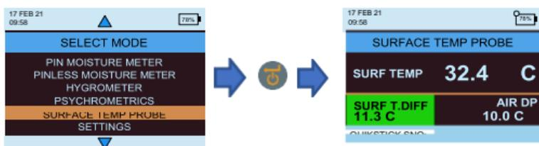
Dans ce mode, le MMS3 mesure la température de surface à l'aide d'une *sonde externe de température de surface* insérée dans la douille et entrant en contact avec la surface à évaluer. En plus de la sonde *de température de surface*, connectez une sonde *d'humidité* pour que le MMS3 affiche l'état de condensation.
