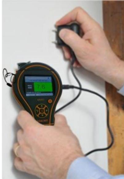
Lorsque l'instrument est en mode Humidité à broches, il affiche par défaut WME BOIS TYPE A (voir le tableau d'étalonnage du bois Protimeter)
