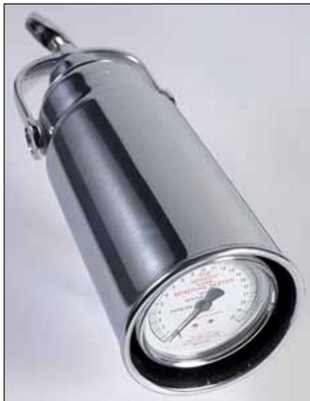
La photographie de gauche montre un Speedy de taille standard. La procédure de test d'humidité est simple à suivre et ne prend que quelques minutes pour la plupart des matériaux. Toutefois, pour garantir des résultats précis et réguliers, la procédure doit être précisément suivie. Pour tester votre échantillon, reportez-vous aux photographies ci-dessous et procédez comme suit :
