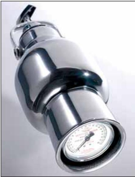
La photographie de gauche montre un Speedy de grande taille. La procédure de test d'humidité est simple à suivre et ne prend que quelques minutes pour la plupart des matériaux. Toutefois, pour garantir des résultats précis et réguliers, la procédure doit être précisément suivie. Pour tester votre échantillon, reportez-vous aux photographies ci-dessous et procédez comme suit :
